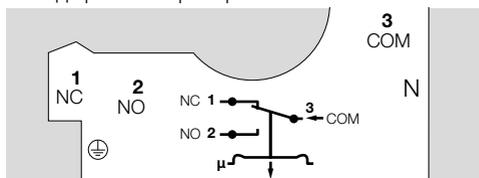
У датчиков с настройкой избыточного давления удалите находящийся в приборе шаблон и произведите подключение в соответствии с выгравированной схемой электроподключения.
