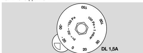
Для датчиков с настройкой отрицательного давления шаблон со схемой подключения находится под крышкой прибора.
